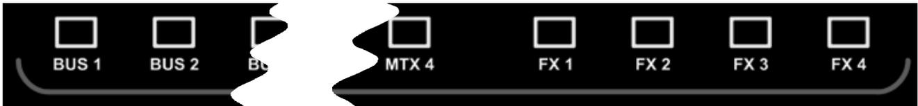
Diese Tasten schalten den Mischer in den MIX-Modus und ermöglichen ein schnelles und müheloses Mischen von Kanälen auf Busse und Effekte oder Bussen zur Matrix. Das Drücken einer beliebigen Taste startet eine Reihe von Events, die das Bedienfeld und Monitoringsystem des Mischpults auf das Layout schalten, das am besten für die gewünschte Funktion geeignet ist.
